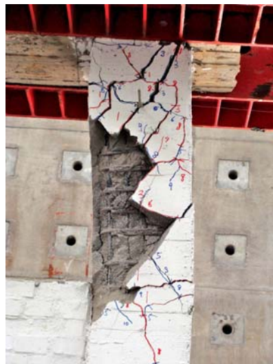
側位移比2%，試體達到極限牆度
