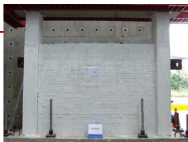
S3試體(短柱補強前)
